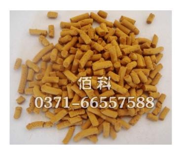
佰科牌氧化铁脱硫剂孔径分布主要以大、中孔为主,主要适用于气相多种硫化物脱除,具有活性高、硫容量大、脱硫效率高,机械强度好,阻力小、易于再生,高压、高温及水浸作用下不易破碎等特占。
